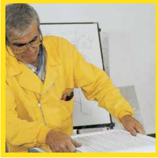
Prefabrik Klima Kanallarına menfezlerin takılması
