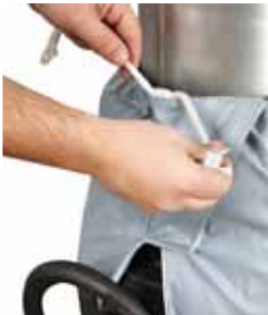
Paslanmaz yay yardımıyla, kopçalar birbirine sıkıca bağlanır.
